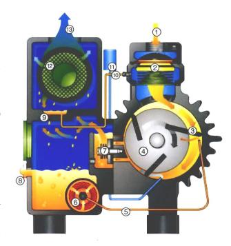
为了避免吸入固体颗粒,真空泵在进气口处安装了进气滤网。
